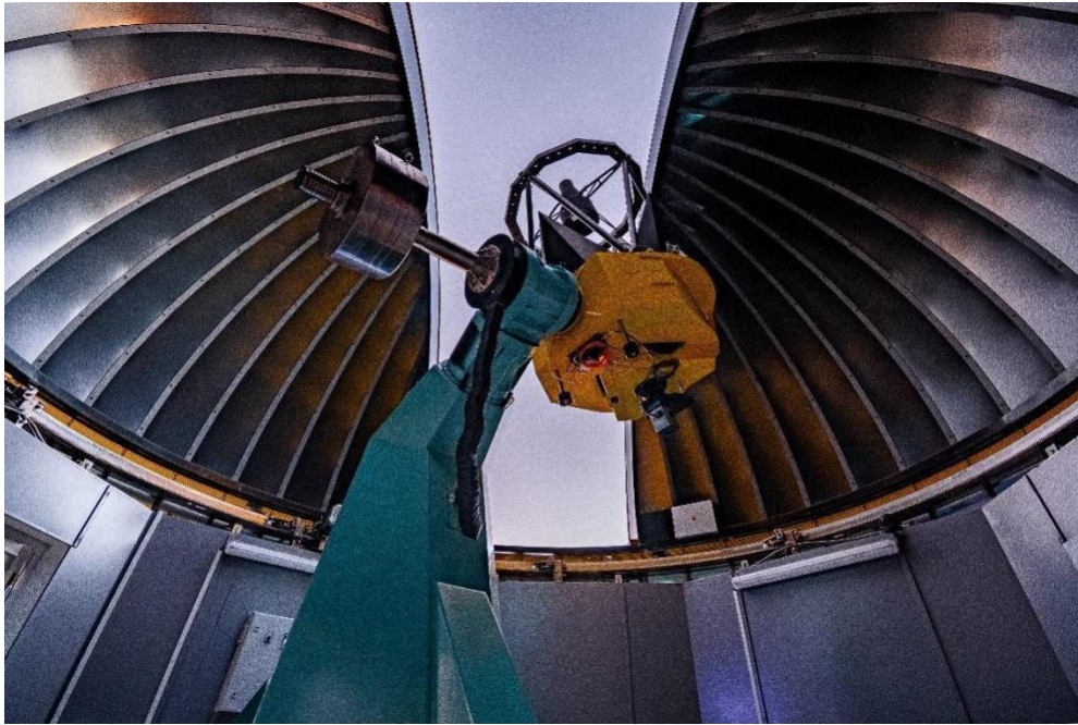
Imagen 3. Telescopio SAINT-EX, con un espejo de un metro de diámetro. Crédito: Instituto de Astronomía, UNAM. E. Cadena.
